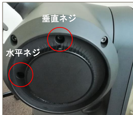
2. 六角棒レンチを使用してネジを回します（この場合は垂直ネジ）
